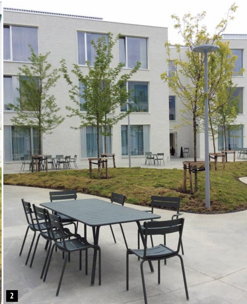
Foto's | 1 | De centrale binnentuin die overgaat in het groendak. | 2 | De verhardingen wateren af naar de groenzone, die voorzien is van een grindkoffer met draineerbuisen aan de rand van het plantvak.
